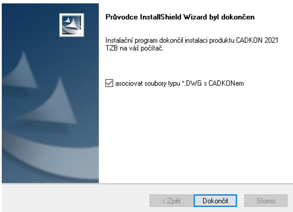
V tomto dialogu je možno vybrat asociování souborů typu DWG (formát výkresu AutoCADu) s CADKONem TZB při dvojkliknutí myši (nebo označení a stisknutí Enter) např. v MS Průzkumníku na soubor typu DWG, bude spuštěn automaticky CADKON TZB a soubor jím bude načten.
